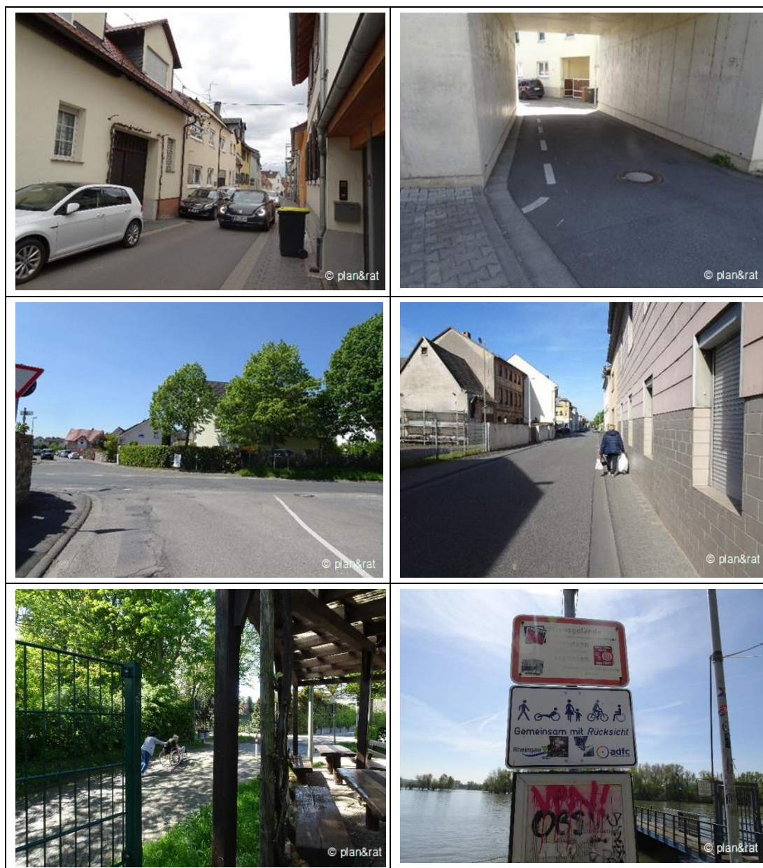
Abb. 3-4: Zugeparkte bzw. fehlende Gehwege (Mühlstraße, Bahnunterführung Obere Schwemmbach (oben), fehlende Querungsstelle (Schillerstraße/ Greiffenclaustraße (Mitte links), zu schmalen Gehweg (Rheingaustraße) (Mitte rechts), mangelhafte Barrierefreiheit (Unterführung Oestricher Kran) (unten links), Gegenseitige Rücksichtnahme auf dem Leinpfad (unten rechts)
